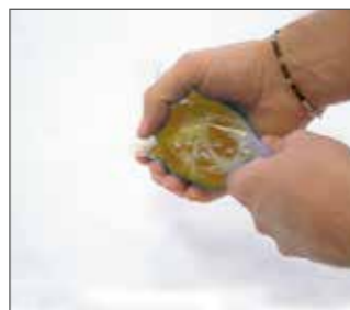
2.- Mezclar componentes Retirar barrera entre los componentes y mezclar 1 min. convenientemente hasta lograr un color homogéneo de la misma.
